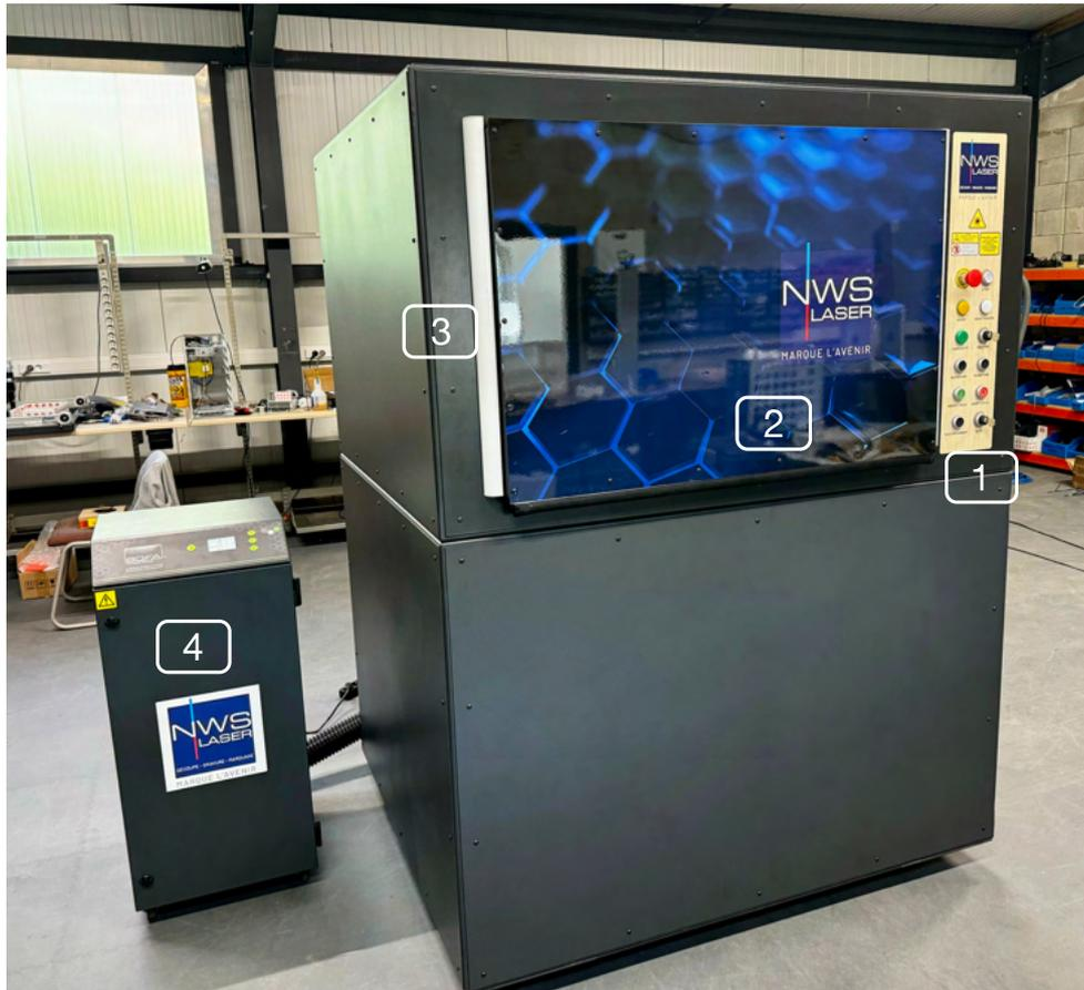
La machine LASERIX 3D doit être posée sur une surface parfaitement plane, suffisamment robuste pour supporter le poids de la machine.
