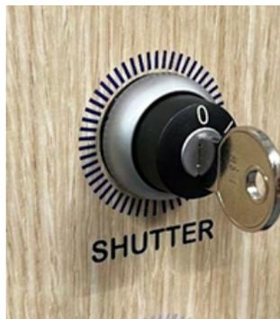
Le shutter est de type manuel à clé. Il consiste en un système de blocage de la sortie du faisceau laser. Sur la position 0 la clé bloque le faisceau, sur la position 1, le laser peut tirer, le faisceau n'est plus bloqué et le voyant LASER ACTIF s'illumine.
