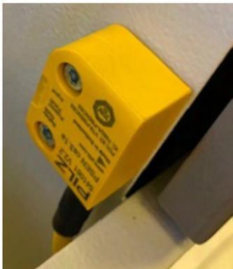
Le contrôle de l'ouverture/fermeture de la porte est assuré par un interrupteur magnétique PILZ. L'interrupteur est lui-même relié à une entrée de sécurité de l'automate de la machine.
